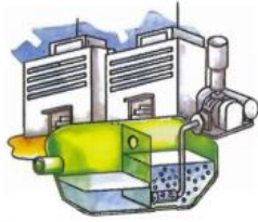
■ 公寓大楼的污水处理 (曝气) Waste water Aeration in Condominiums
